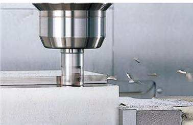
對SUS304也能穩定進行高性能加工(進給速度Vf=1,140mm/min)。
