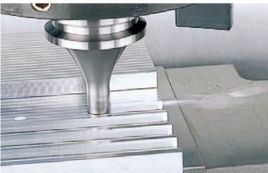
對鋁合金A2017進行高速加工(轉速n=12,000min<sup>-1</sup>)，亦能得到美觀的切屑及加工表面。
