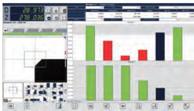
多刀式偏擺量測功能 / Run-Out function
